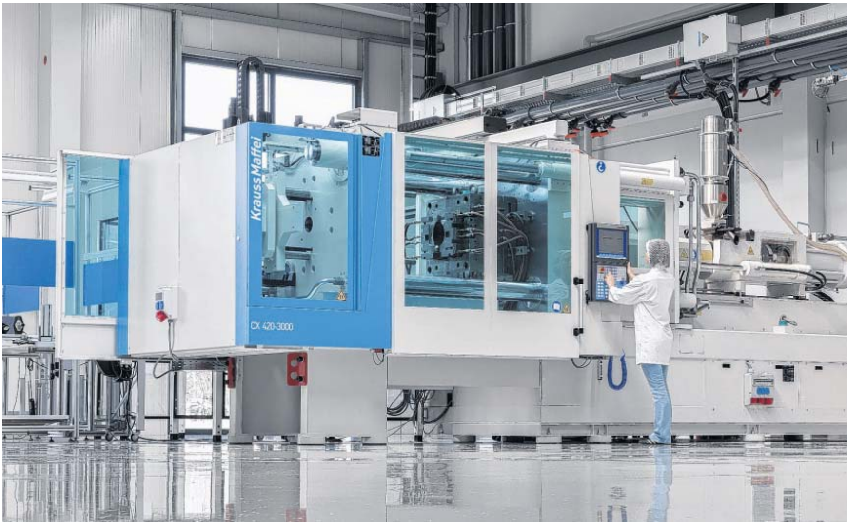
In der Fertigung: Auszubildende zum Verfahrensmechaniker lernen den Umgang mit Hochleistungsspritzgussmaschinen zur Produktion von Kunststoffteilen für die Kosmetik-, Medizin- und Lebensmittelindustrie. FOTO: COSMED
