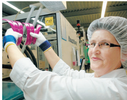
Kontrolle: Karina Schlothauer hält die Bügel für die Wasserkannen unter Licht und prüft so, ob Fehler vorhanden sind.
